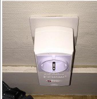
Pose d'un filtre dans la pièce voisine de l'appareil de mesure. *Protocole utilisé : le filtre est posé dans un endroit propre, à l'abri des passages, sur une prise de courant non utilisée. Les mesures sont faites dans une autre pièce.*
