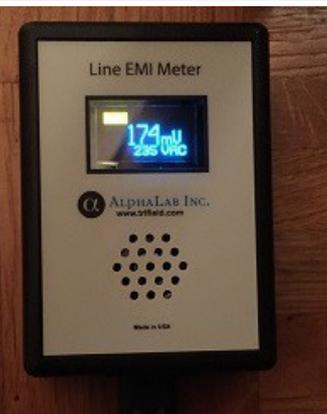
Mesure dans l'entrée avec le 2ème filtre mal placé : 175 mV
