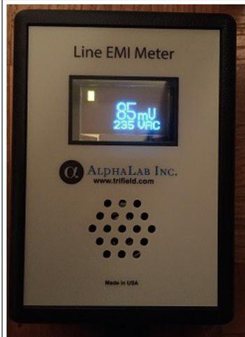
Mesure dans l'entrée avec 2 filtres : 85 mV
