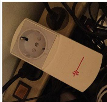
Pose du 2ème filtre dans une zone fortement polluée (ordinateur, alim, multiprise non blindée). La situation se dégrade. On passe de 100 avec un filtre, à 175 avec 2 filtres. D'où l'importance du choix de la prise où mettre le filtre.
