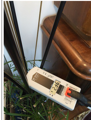
lampe allumée non mise à la terre : 236 V/m.
