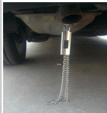
bande antistatique (bande anti-vomi), servant à éliminer l'électricité statique d'un véhicule.
