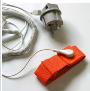
Earthing du commerce: bracelet de mise à la terre, avec résistance interne de protection de 100 KOhm.
