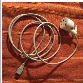
Câble USB-terre réalisé à partir d'un câble blindé d'imprimante, servant à mettre à la terre un ordinateur portable
