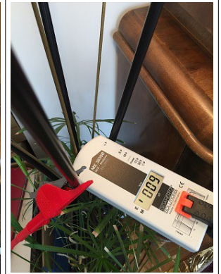
lampe allumée mise à la terre : 9 V/m
