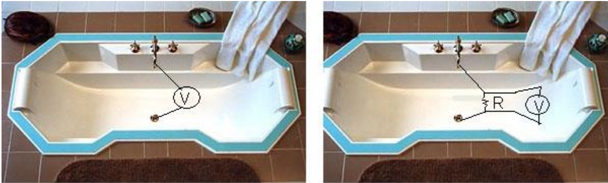
Figure 3-2: Mesure en circuit ouvert (gauche); mesure en circuit fermé aux bornes d'une résistance de 1k\Omega
